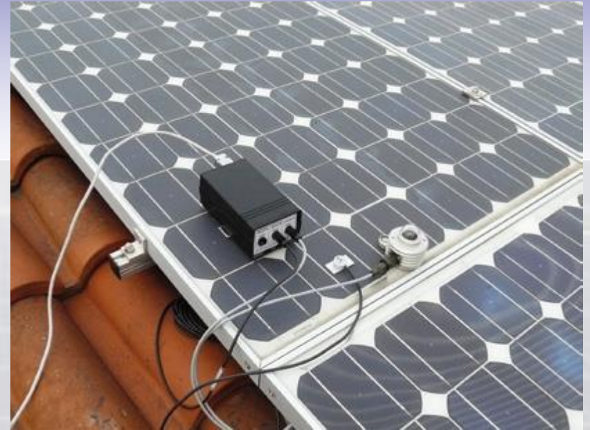
Pyranomètre et accessoires de communication. Transmission en temps réel de données.
